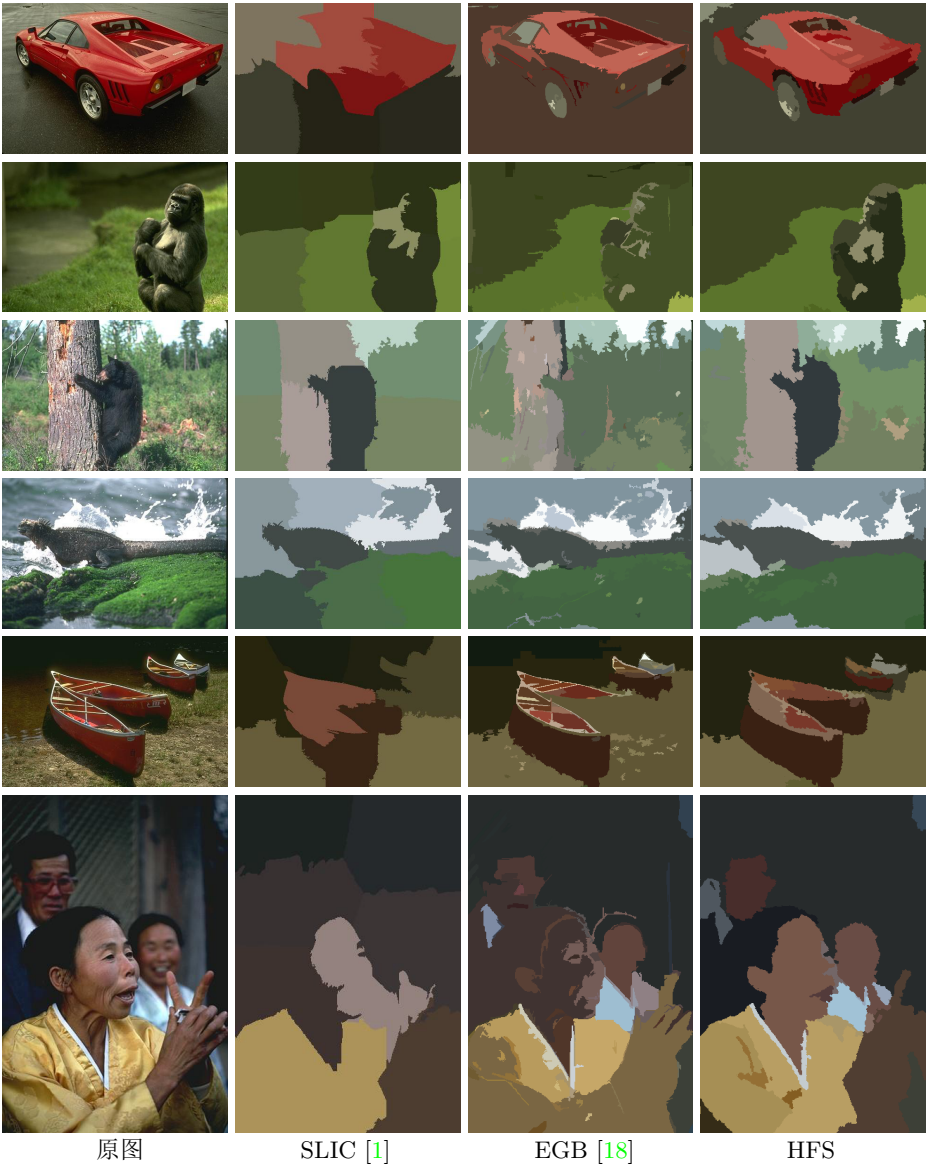
图 5: EGB、SLIC 和我们的方法的一些示例。我们之所以仅与这两种算法进行比较，是因为它们是仅有的两种足以在应用程序中使用的高效算法。左：图像；左中：SLIC；右中：EGB；右：我们的。区域由其平均颜色表示。所有图片均来自 BSDS500 测试集 [4]。
